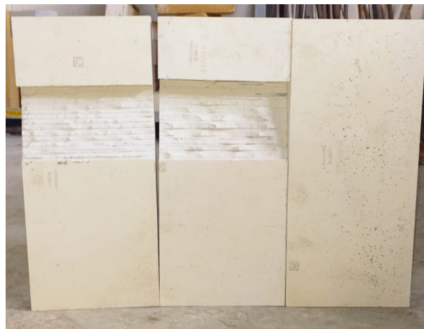
Figura 6 – Amostras de refratários após desgaste simulado: ROI 1 (36 mm), ROI 2 (30 mm) e ROI 3 (76 mm).
