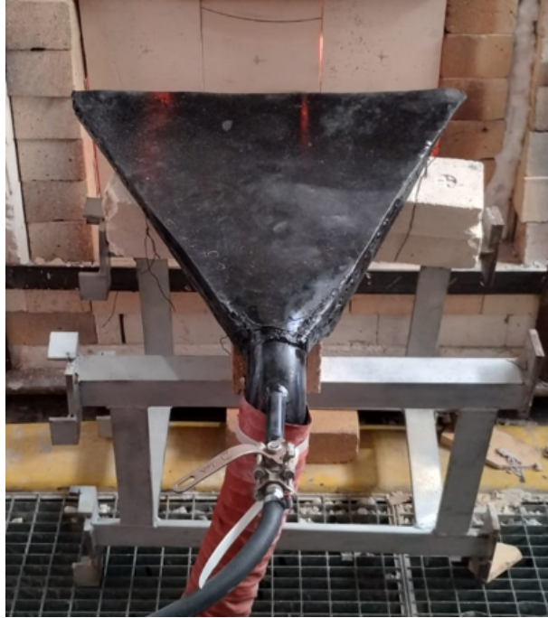
Figura 7 – Dispositivo de ventilação "bico de pato".
