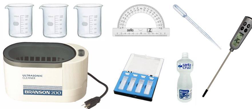
Figura 3.5: Equipamentos e materiais utilizados durante a preparação e manuseio das amostras, com exceção apenas do transferidor que foi utilizado para medir o ângulo do sensor em relação ao feixe do laser.
