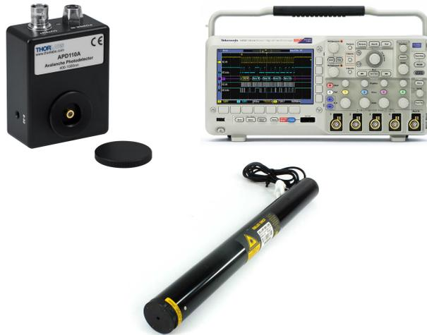
Figura 3.4: Equipamentos ópticos utilizados na composição final do nosso experimento de DLS. No canto superior esquerdo, está o fotodetector APD110A da Thorlabs. À direita do fotodetector, encontra-se o osciloscópio MSO2024B da Tektronix com resolução de 200 MHz e capacidade de amostragem de 1 GSa/s. No centro, logo abaixo desses itens, está o laser He-Ne da Melles Griot com comprimento de onda de 632 nm e potência de 1,6 mW.
