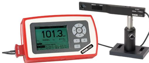
Figura 3.1: Detector de potência óptica PM100D da Thorlabs utilizado nas etapas iniciais desta pesquisa. Esse dispositivo é equipado com um sensor do tipo fotodiodo e conta com um software especializado para computadores, que permite tanto o controle do equipamento quanto o armazenamento dos dados medidos.
