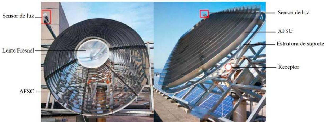
Figura 2.18: As fotos do AFSCFL em condição experimental. Adaptado de [12].
