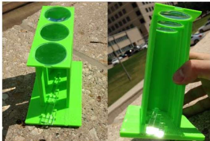
Figura 2.31: O dispositivo de três sistema de guia de onda de lente para canal. Fonte: [17].
