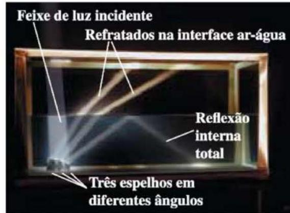
Figura 2.34: Um feixe de luz entra na parte superior esquerda do aquário e, depois, reflete na parte inferior dos espelhos inclinados em diferentes ângulos. Um feixe sofre reflexão interna total na interface ar-água . Fonte: [35].
