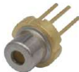
Figura 3.1: Laser de Diodo L405P150 can type para 405 nm, com potência máxima de 150 mW. Fonte: Thorlabs.
