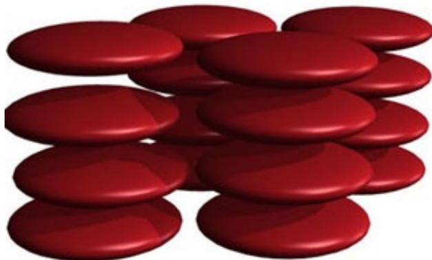
Figura 2.11: Esquema apresentando a fase colunar [6].
