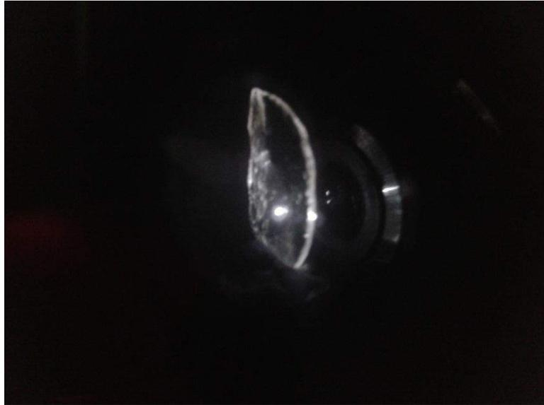
Figura 3.27 Amostra de  $Pr^{3+}$  0,1 % e  $Yb^{3+}$  2 % luminescente pela excitação do laser de 0,5 W.
