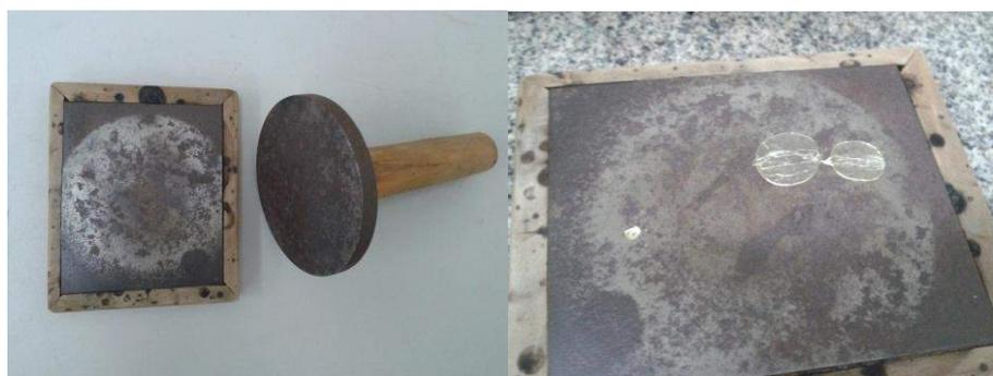
Figura 2.1 Chapas de ferro utilizadas para resfriar o  $\text{PbGeO}_3$ .
