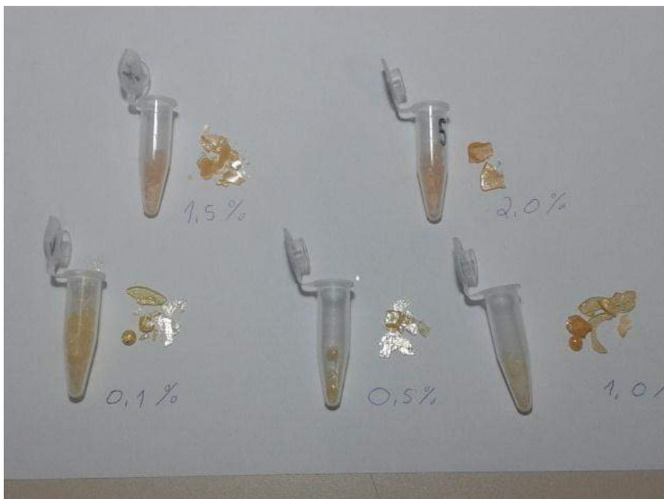
Figura 3.12 Foto das amostras obtidas de fluorogermanato dopados com  $\text{Er}^{3+}$  em diferentes concentrações e  $\text{Yb}^{3+}$  fixo em 2%.
