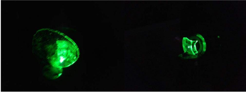
Figura 3.23 Fotos das amostras de  $\text{PbGeO}_3 : \text{PbF}_2 : \text{BaF}_2$  dopadas com  $\text{Er}^{3+}$  sensibilizadas por  $\text{Yb}^{3+}$  (Esquerda 2 %  $\text{Yb}$  e 0,5 %  $\text{Er}$ ) (Direita 1 %  $\text{Yb}$  e 0,1 %  $\text{Er}$ ).
