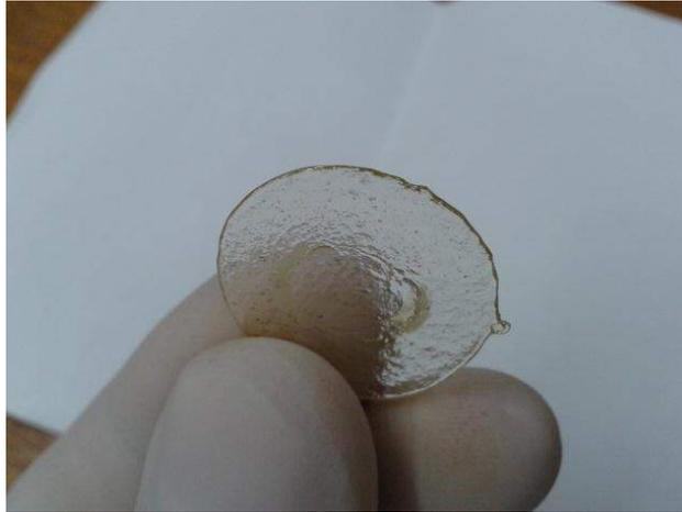
Figura 2.4 Amostra com 90%  $\text{PbGeO}_3$  : 5%  $\text{PbF}_2$  : 5%  $\text{BaF}_2$  dopados com 2 %  $\text{Yb}^{3+}$  e 0,075 %  $\text{Pr}^{3+}$ .
