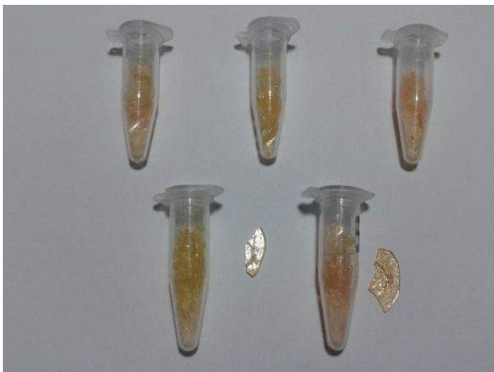
Figura 2.2 Amostras de 80 %  $\text{PbGeO}_3$  : 10 %  $\text{PbF}_2$  : 10 %  $\text{MgF}_2$  com  $\text{Yb}^{3+}$  e  $\text{Er}^{3+}$ .
